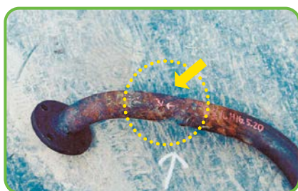
⑤骨材の亀裂、折損、二次接着部の剥離
